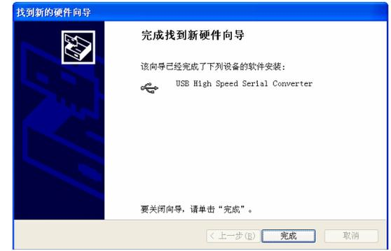
这是完成了安装转换器的第一个步骤, 第二个步骤涉及到安装串口。一旦转换器的安装正确完成后, 串口会自动的安装系统中。
